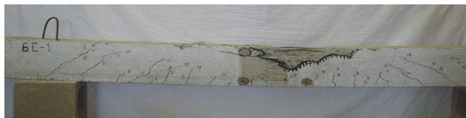
Рис. 5. Характер руйнування балок серій БР (а) і БС (б).
